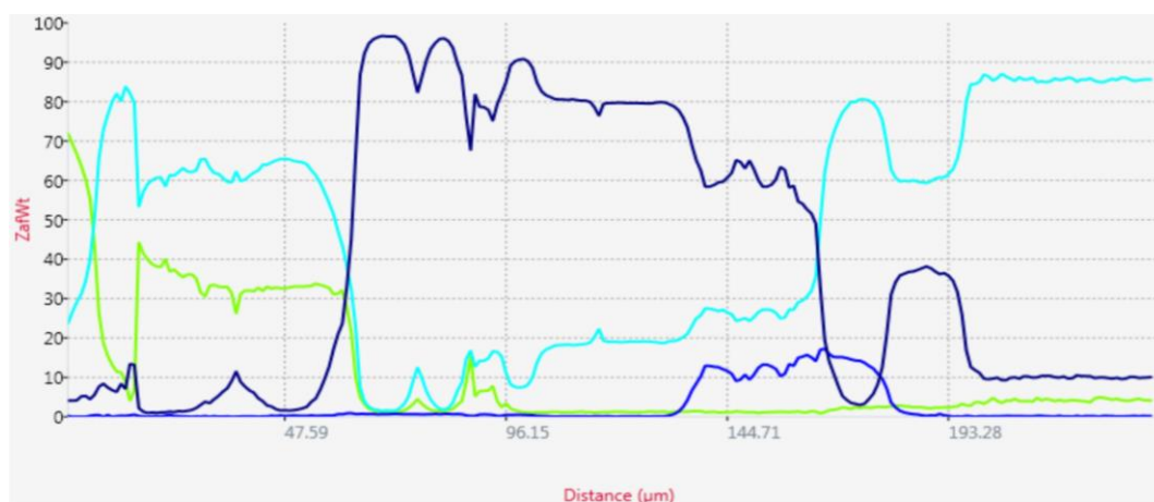
Рисунок 54 – Структура покрытия на линии сканирования (а) и распределение химических элементов (б) по толщине покрытия после диффузионного отжига при 850°C и выдержке 1 часа.
