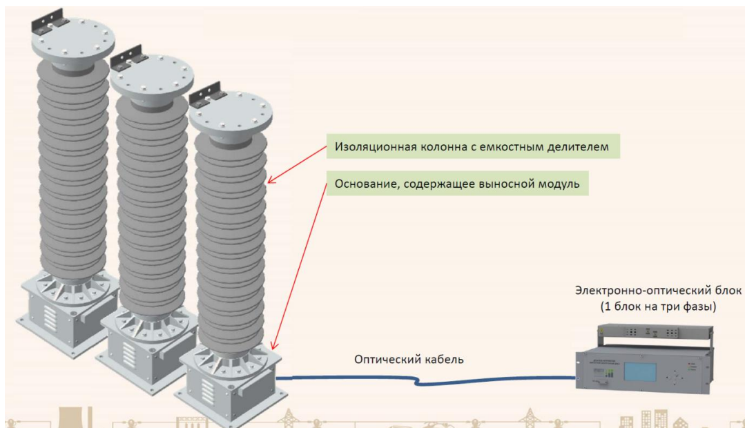
Рисунок 11 – Структурная схема оптических ТН
