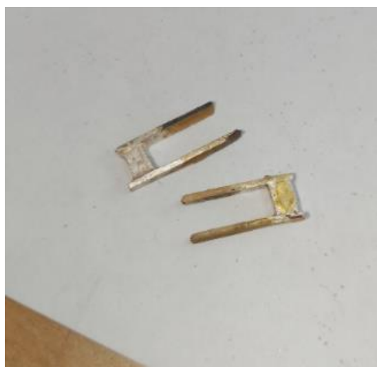
Рисунок В.12 – Этапы изготовления замка на серьги
