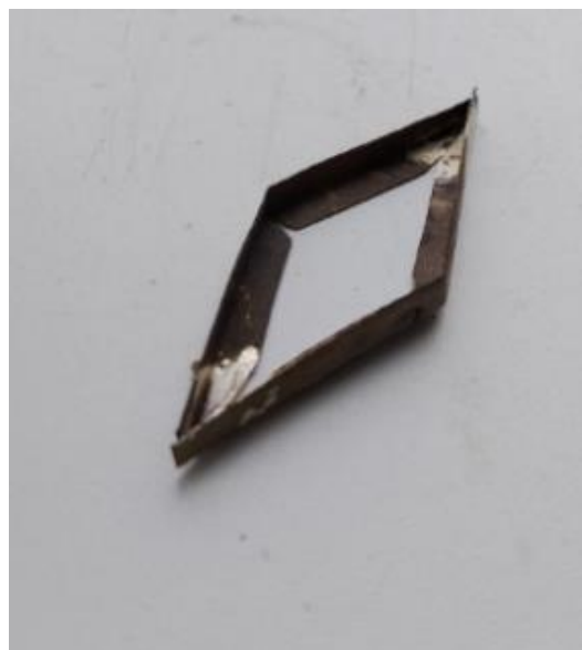
Рисунок В.9 – Пайка каста под зеркало
