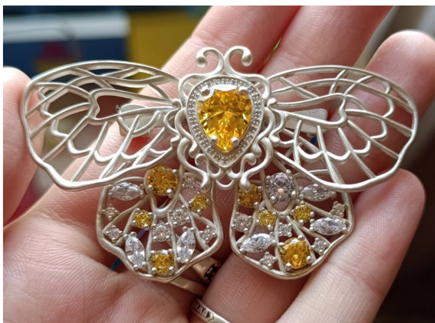
Рисунок Г.15 – Брошь «Мотылёк» после шлифовки и закрепки камней, А.А. Баринаова, ДПИБ-2001а, ТГУ, 2024 г.
