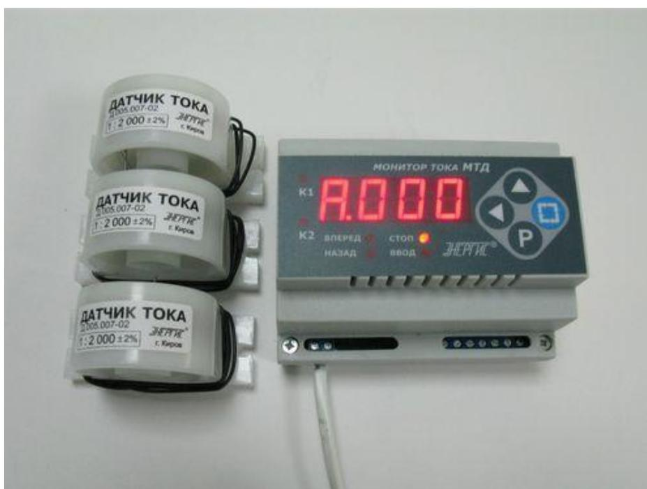
Рисунок 3 – Монитор тока двигателя
