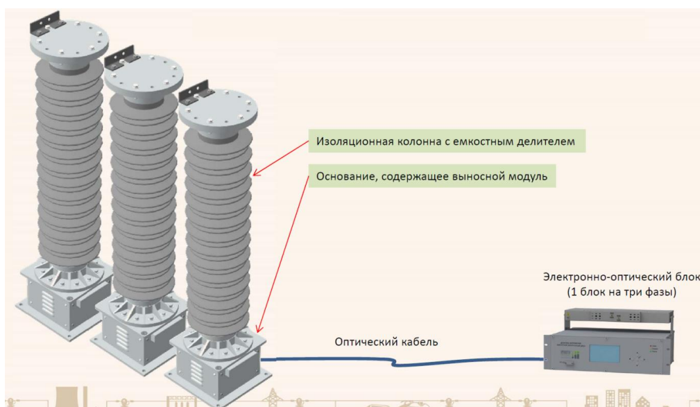
Рисунок 11 – Структурная схема оптических ТН
