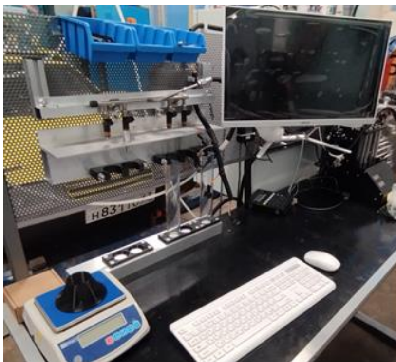
Рисунок 15 – Комбинированный стенд определения динамической и статической производительности форсунок и пульсаций давления в топливной рампе
