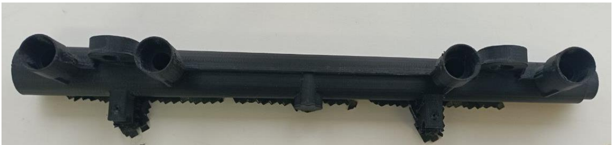
Рисунок 8 – Корпус топливной рампы, выполненный из ABS пластика
