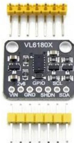
Рисунок 17- датчик расстояния VL6180X
