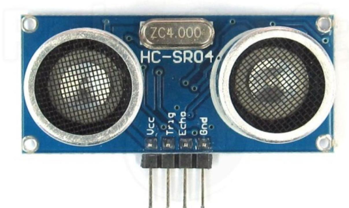
Рисунок 13 – Ультразвуковой датчик расстояния HC-SR04
