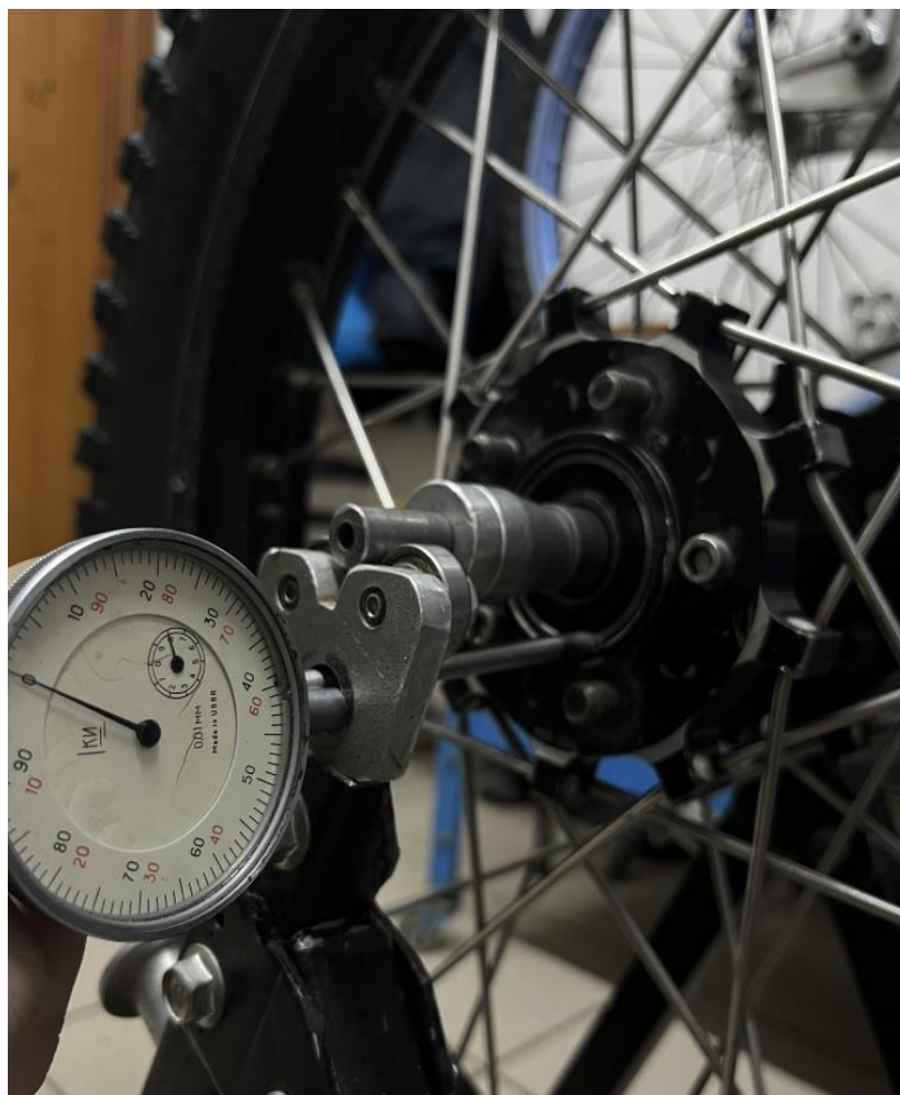
Рисунок 27 – Измерение торцевого биения часовым индикатором
