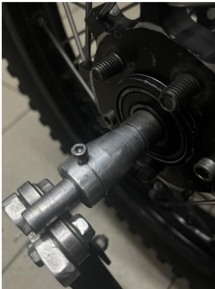
Рисунок 26 – Установка оцетрованного колеса с осью на вращающиеся ролики
