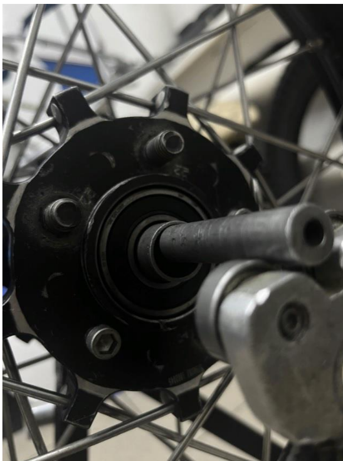
Рисунок 23 – Наглядный пример болтания ступицы колеса на оси
