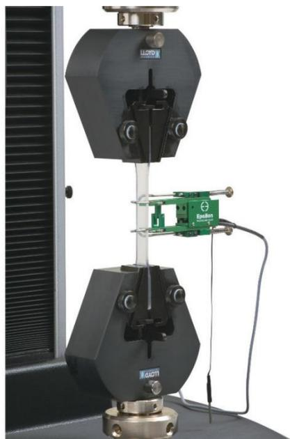
Рисунок 14 – Разрывная машина.
