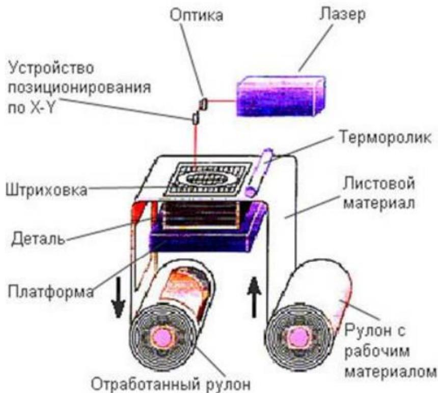
Рисунок 27 – Процесс прототипирования методом LOM
