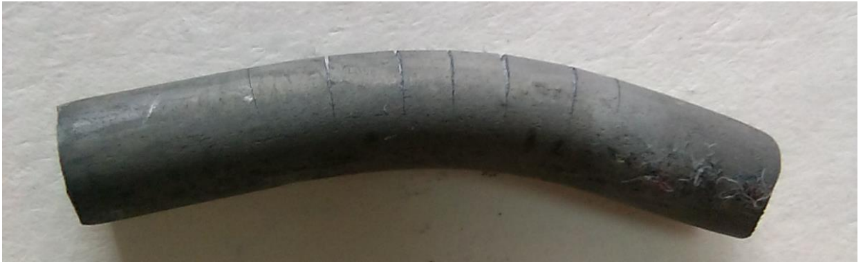
Рисунок Е.1 - Внешний вид фиксатора после испытания на изгиб 30° из стали 10
