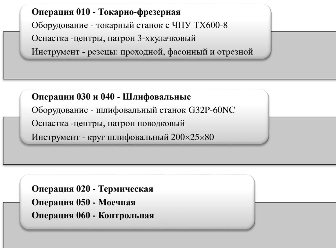
Рисунок 5 – Краткое описание разработанного технологического процесса
