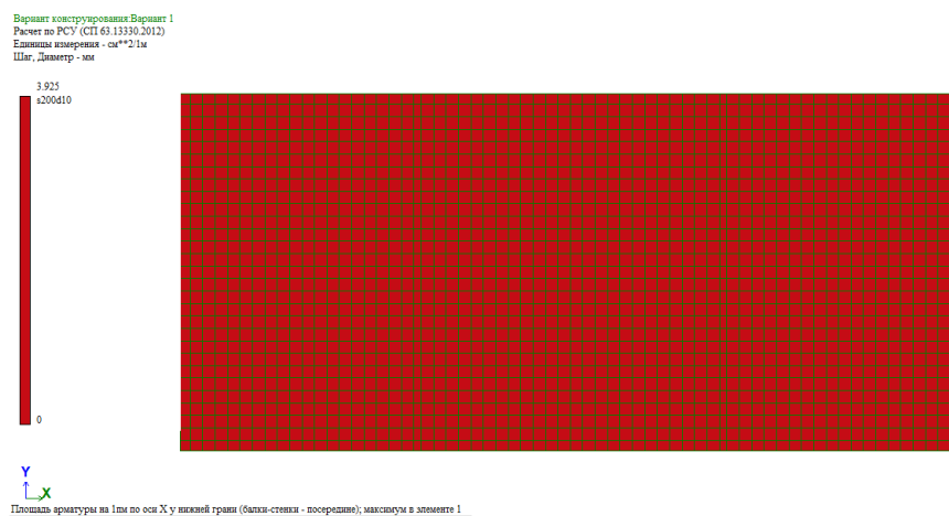
Рисунок 8 – «Подбор нижней продольной арматуры плиты по оси X» [10]
