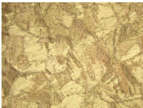
Титановый ( $\alpha+\beta$ ) – сплав мартенситного класса марки ВТ3-1
