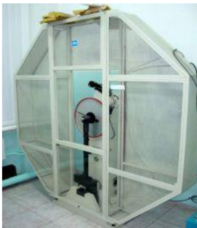
Рисунок 14 – Маятниковый копер с компьютерным управлением предназначен для определения ударной вязкости материалов
