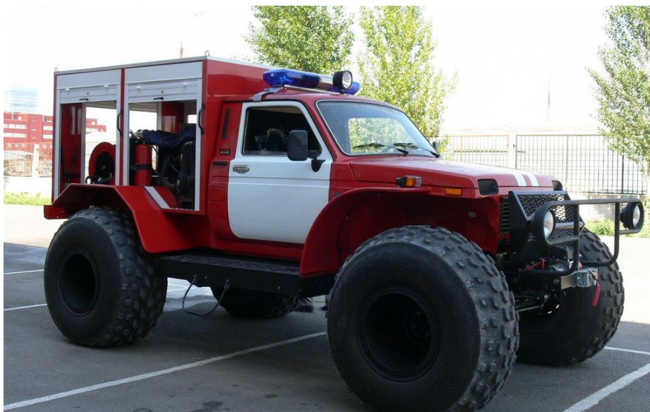
Рисунок 8 – Снегоболотоход «МАРШ» пожарный автомобиль
