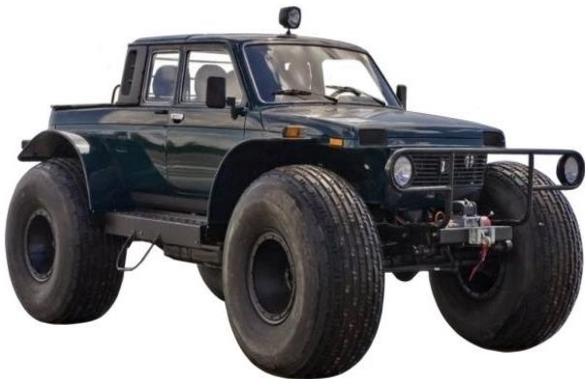
Рисунок 5 – Снегоболотоход «МАРШ-Пикап» с открытой грузовой платформой
