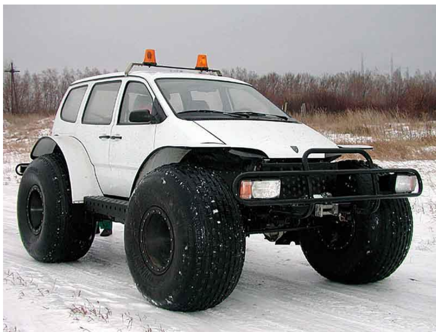
Рисунок 2 – Снегоболотоход «МАРШ-2» с кузовом от минивэна ВАЗ-2120 «Надежда»
