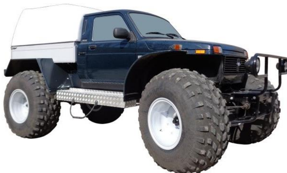
Рисунок 6 – Снегоболотоход «МАРШ-Пикап» с открытой грузовой платформой
