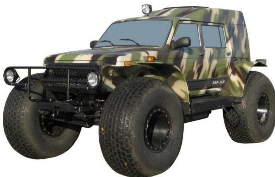
Рисунок 7 – Снегоболотоход «МАРШ-Комби» с увеличенным багажным отделением и задней распашной дверью
