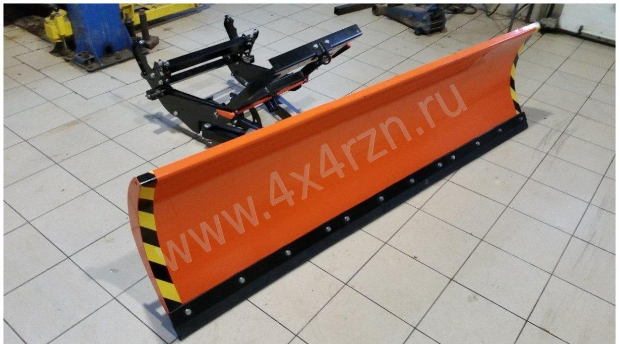
Рисунок 6 – Отвал снегоуборочный серии "Профи" для УАЗ-3163
