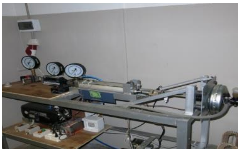
Рисунок 2 – Стенд для проверки автомобильных вакуумных усилителей тормозов
