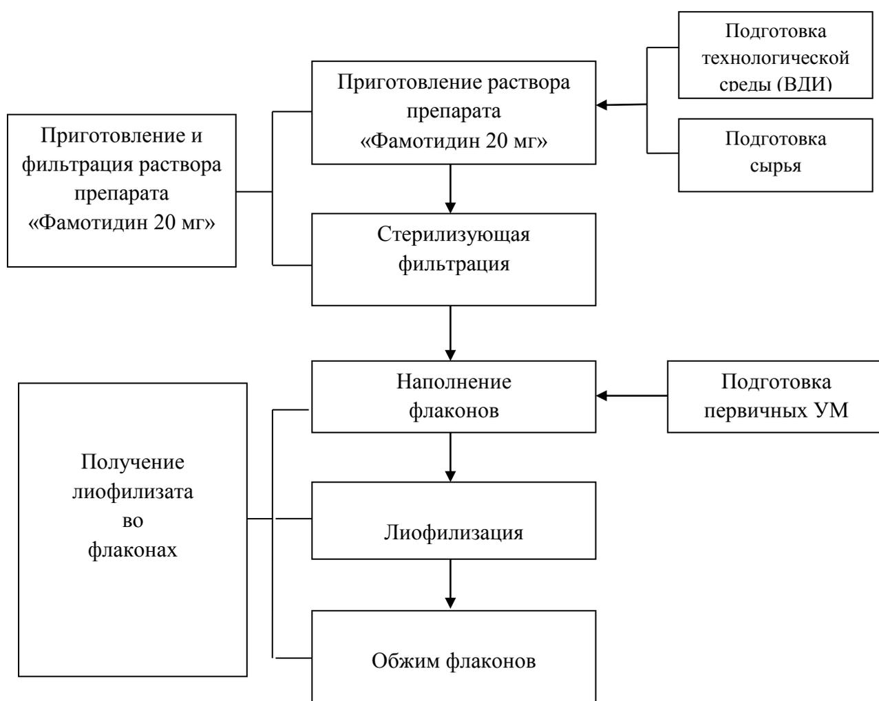
Рисунок 5 – технологическая схема производства лекарственного препарата «Фамотидин лиофилизат 20 мг»
