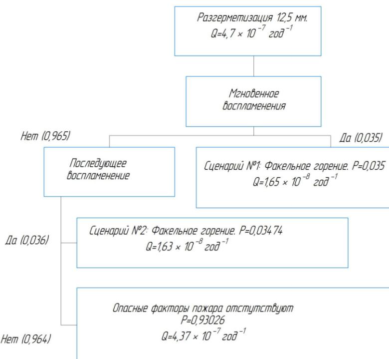
Рисунок 1 – Анализ возможных инцидентов в помещениях котельной АО «УПНП и КРС»
