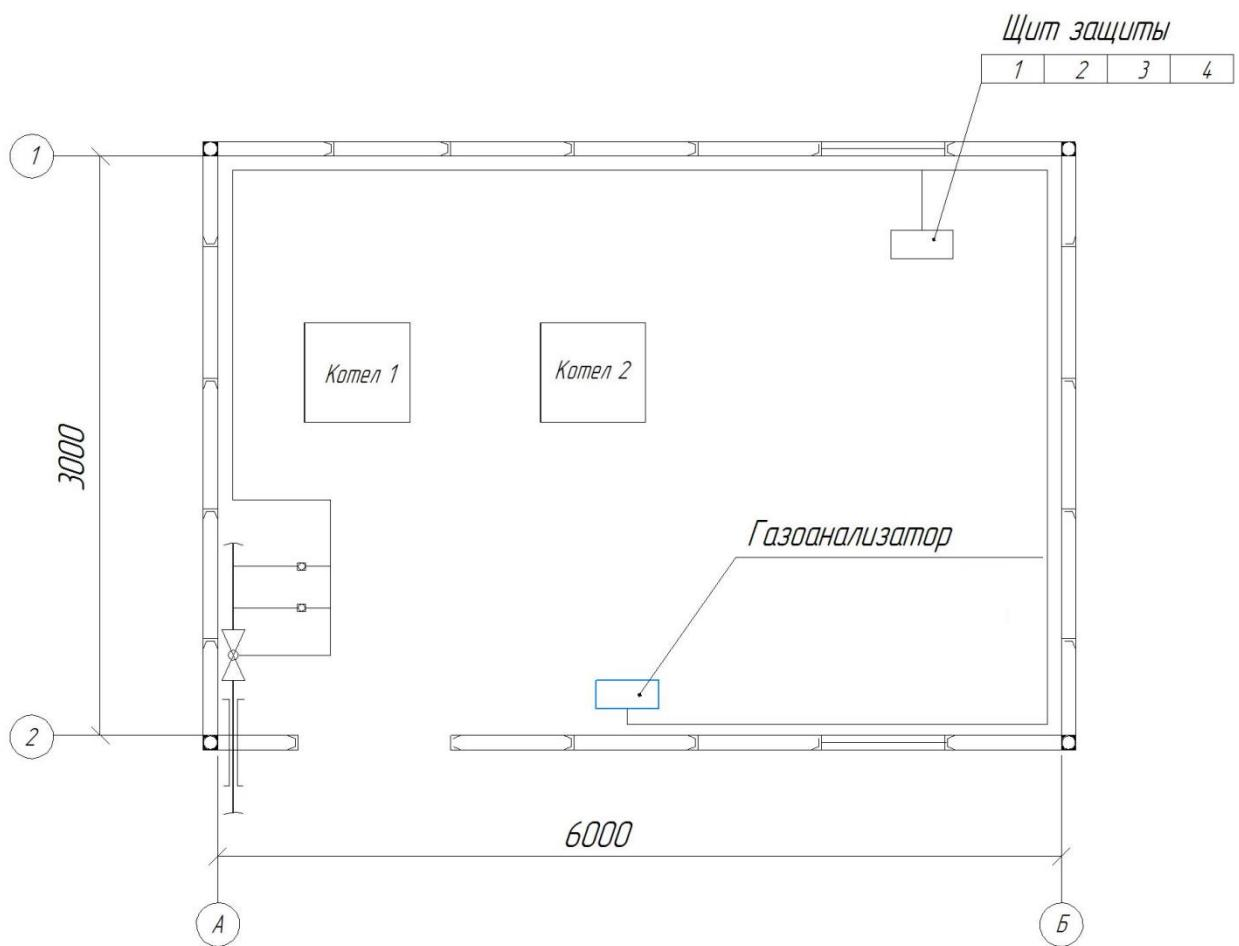
Рисунок 2 – Места установки газоанализаторов NDIR серии S700 SICK МАИНАК в помещениях котельной АО «УПНП и КРС»
