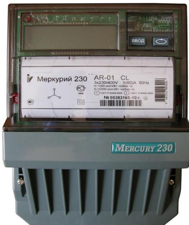
Рисунок 9 – Счетчик электрической энергии «Меркурий 230AR-01CL»
