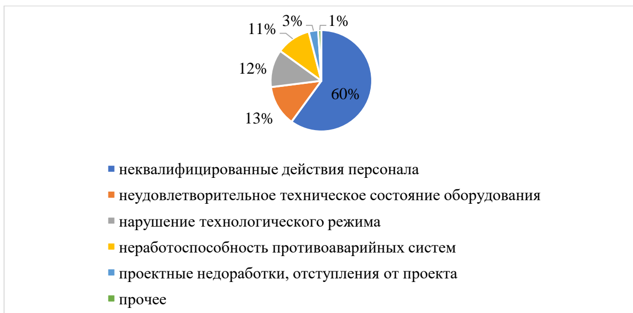
Рисунок 9 – Процентное распределение основных причин аварийности в ООО «Строительно-монтажная компания «РИД»
