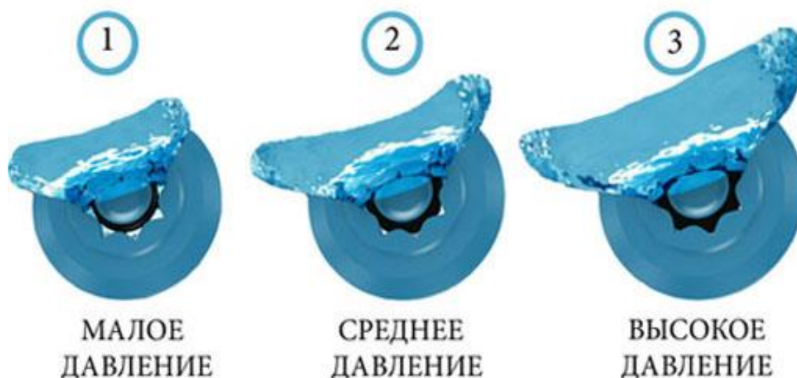
Рисунок 11 – Динамическое кольцо в насадке Savetax
