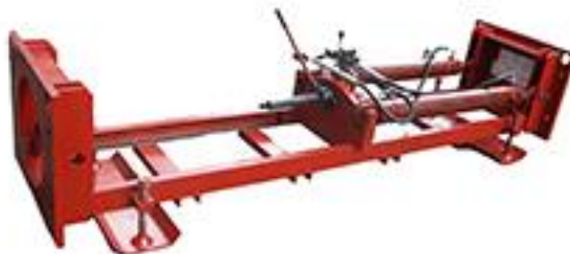
Рисунок 30 – Установка прокола грунта УПГ-25У «Стрела»
