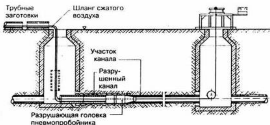
Рисунок 20 – Санация методом продавливания
