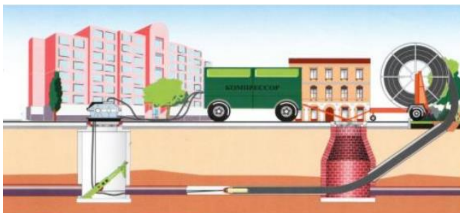
Рисунок 36 – Протаскивание нового трубопровода без разрушения старого
