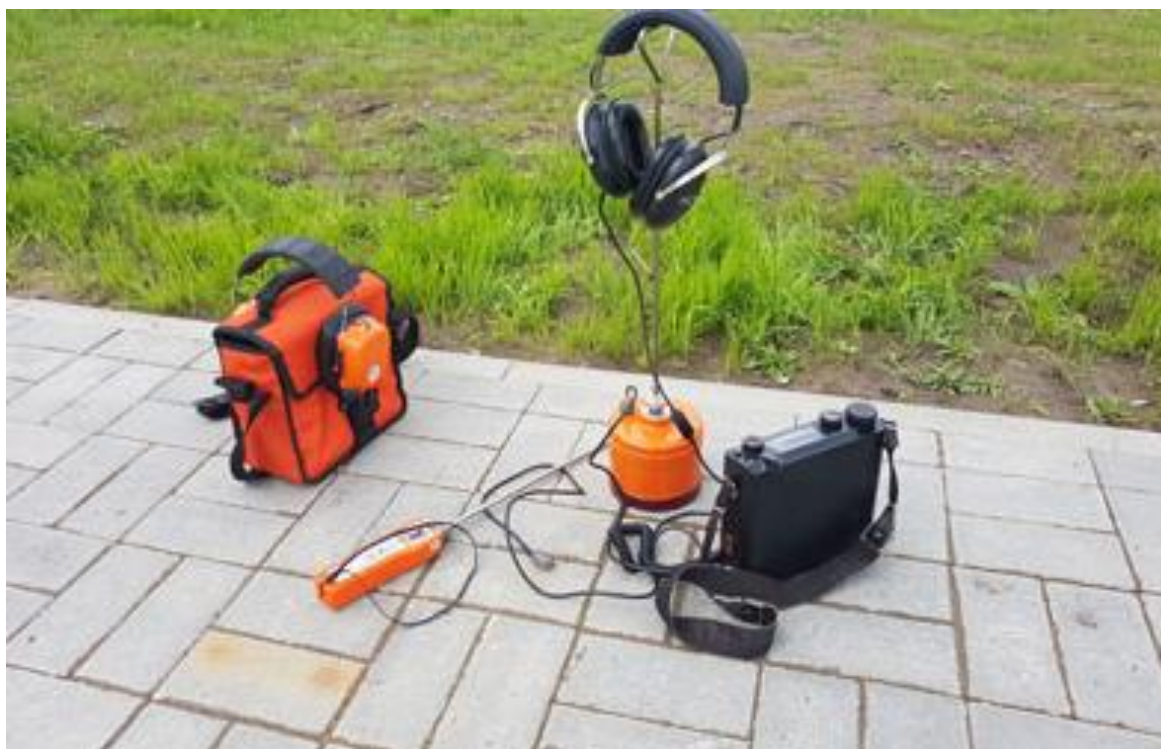
Рисунок 27 – Электроакустический метод уточнения места расположения утечки
