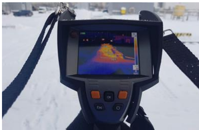
Рисунок 28 – Тепловизионный метод поиска утечек воды
