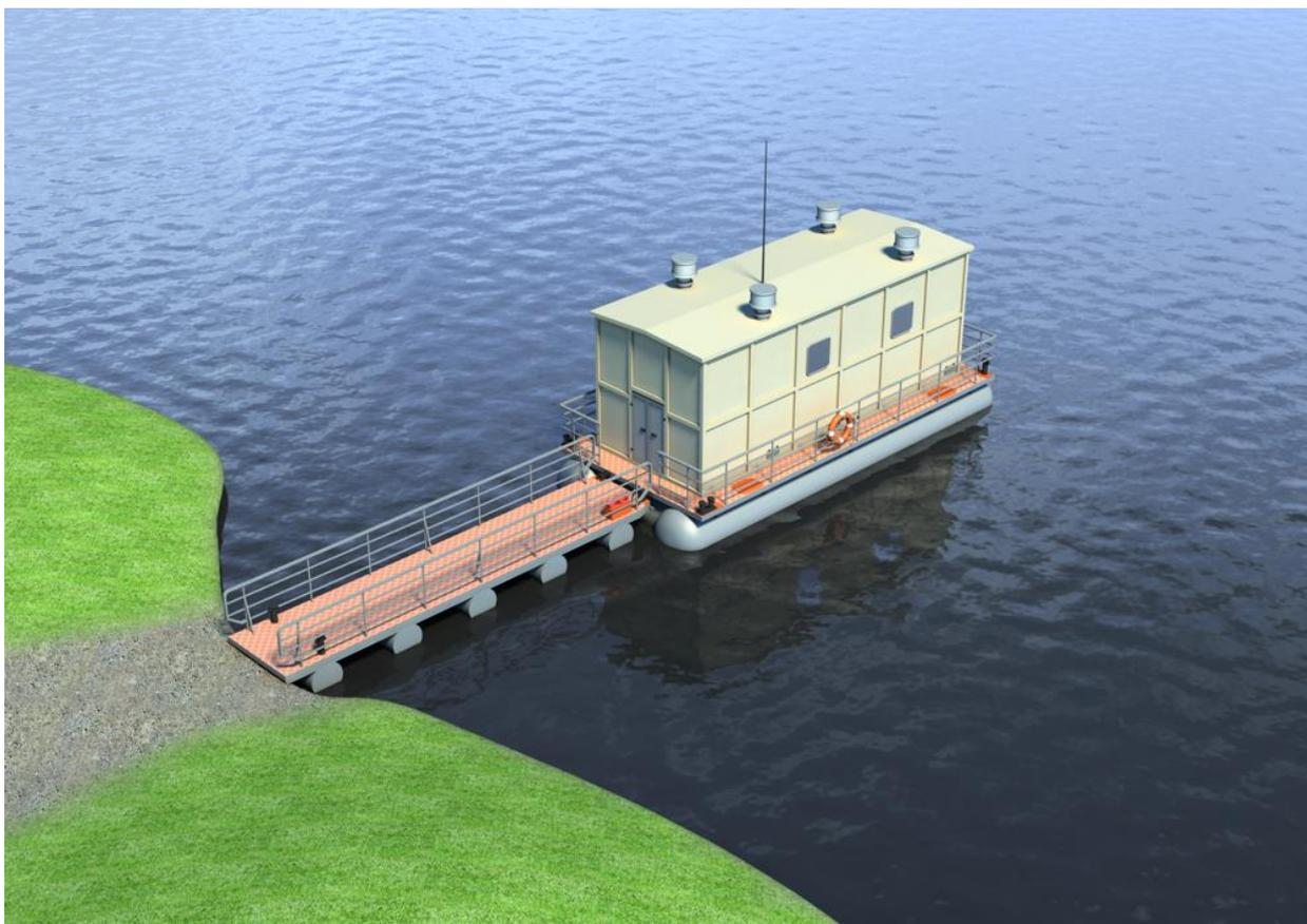
Рисунок 3 – Плавучая станция водозабора
