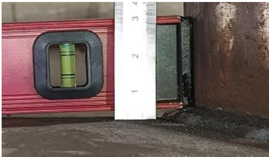
Рисунок 17 – Внешний вид штуцера, приваренного с применением технологии охлаждения
