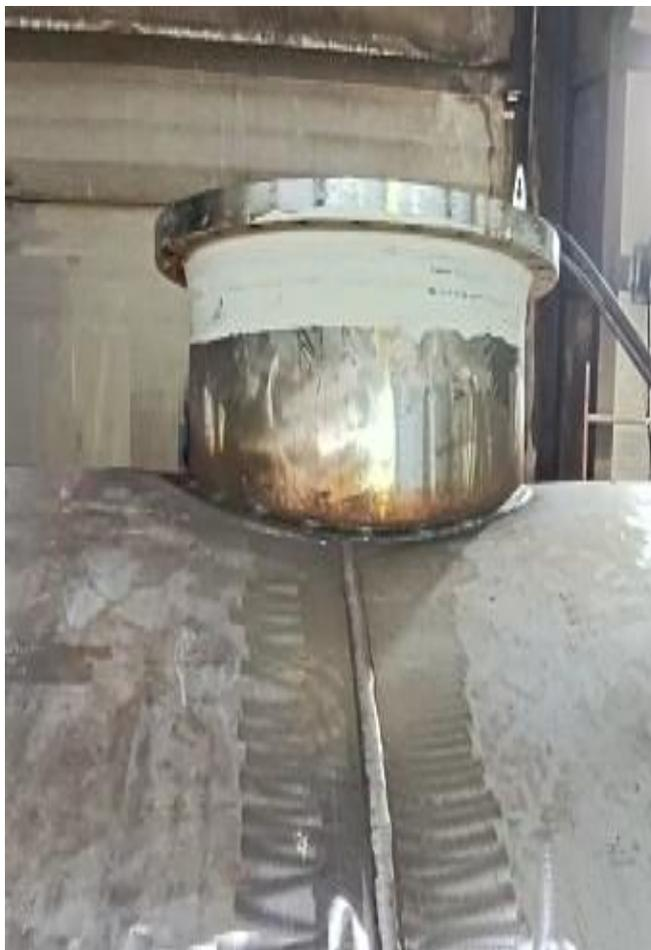
Рисунок 15 – Внешний вид штуцера, приваренного к корпусу
