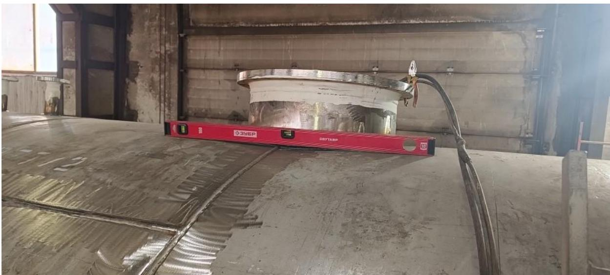
Рисунок 4 - Деформация при сварке штуцера с корпусом
