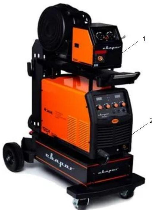
1- Механизм подачи проволоки, 2- CS-501Сварог TECH MIG 5000
