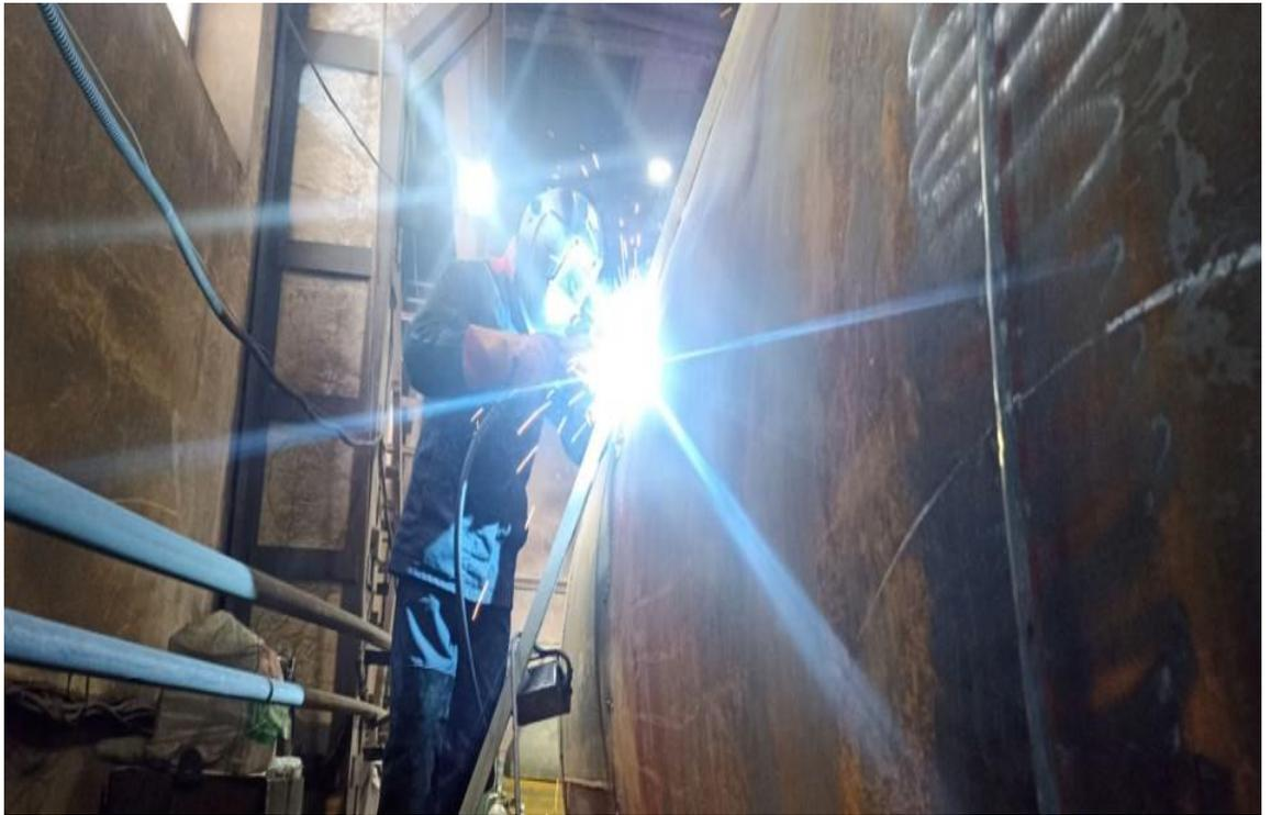
Рисунок 10 – Механизированная сварка плавящимся электродом в газах
