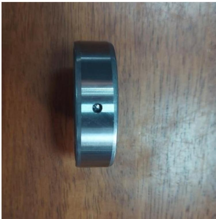
Рисунок 19 – Подшипник с внесенным дефектом
