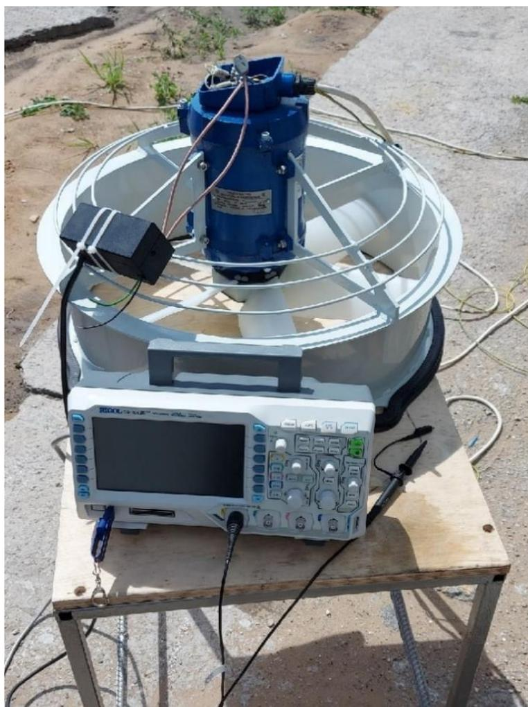
Рисунок 37 – Имитация работы асинхронного электродвигателя в составе вентилятора охлаждения силового трансформатора
