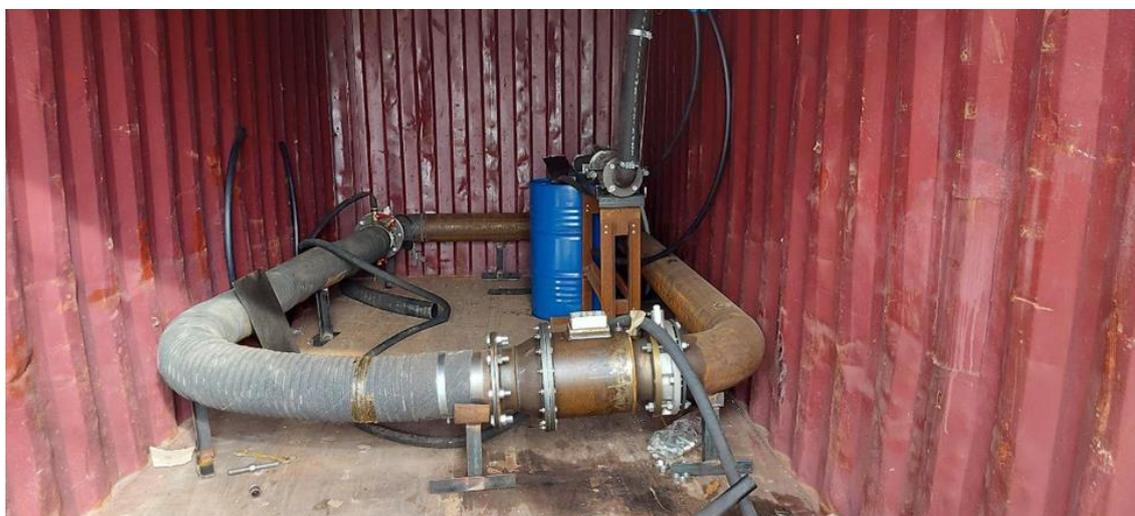
Рисунок 33 – Испытательный стенд, имитирующий работу масляной системы охлаждения силового трансформатора с принудительным охлаждением
