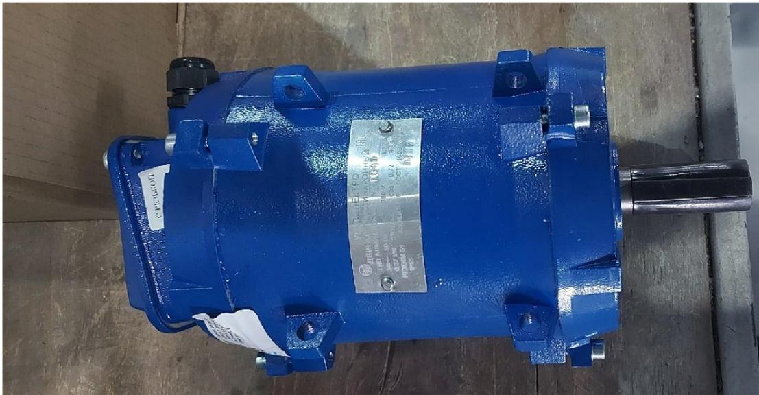
Рисунок 38 – Двигатель используемый в экспериментальной вентиляторной установке
