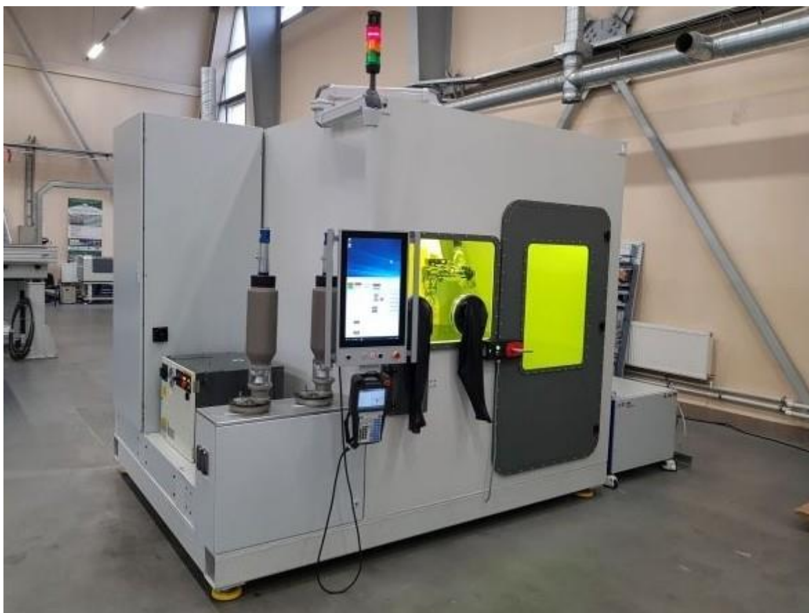
Рисунок 14 – Общий вид установки прямого лазерного выращивания
