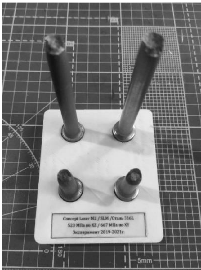
Рисунок 9 – Горизонтальный и вертикальный образец после испытаний
