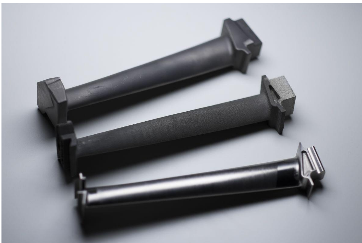
Рисунок 11 – Лопатки газотурбинного двигателя, изготовленные методом EBМ
