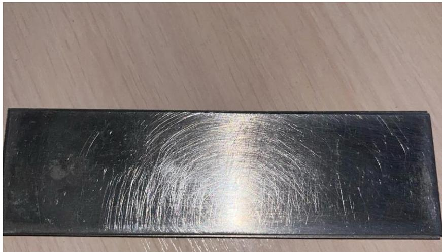
Рисунок 36 – Механическая зачистка зоны сварки
