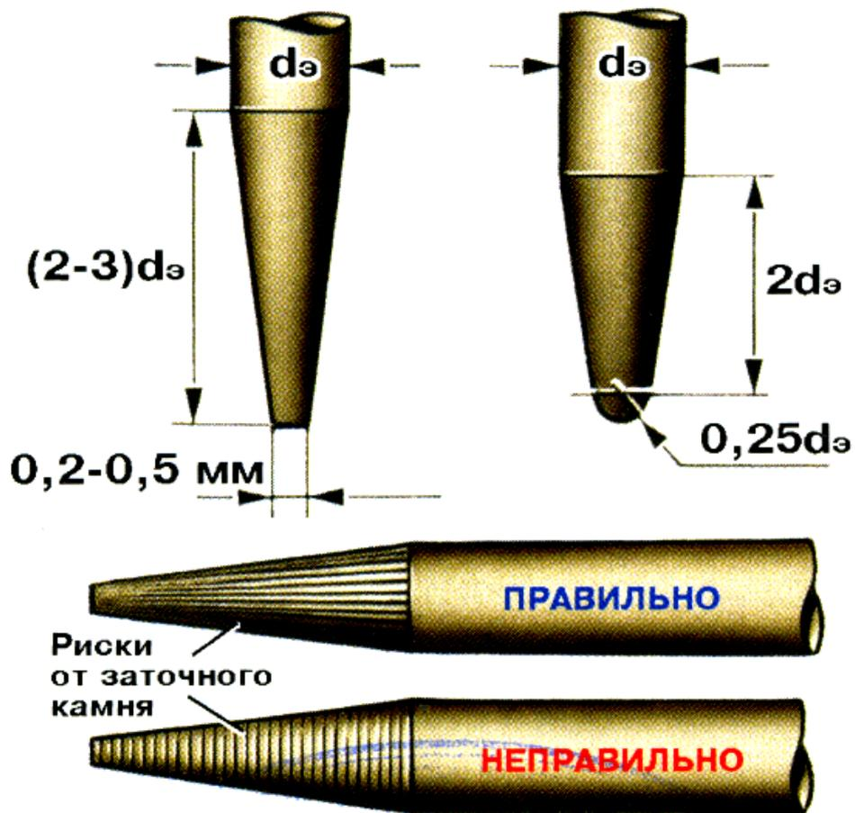
Рисунок 38 – Схема заточки неплавящегося электрода
