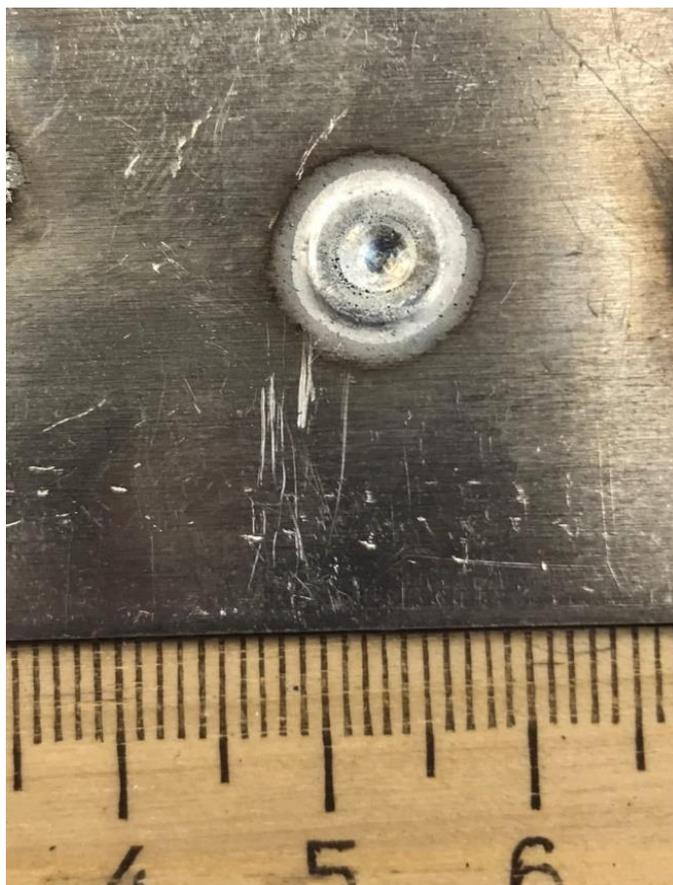
Рисунок 29 – Геометрические размеры точки
