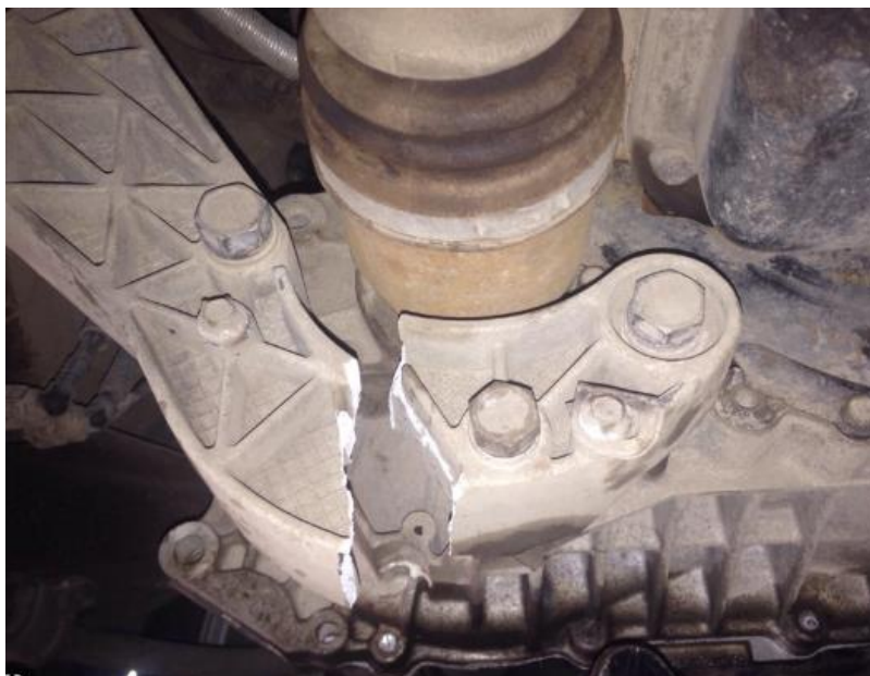
Рисунок 1 – Разрушенный задний кронштейн крепления силового агрегата двигателя
