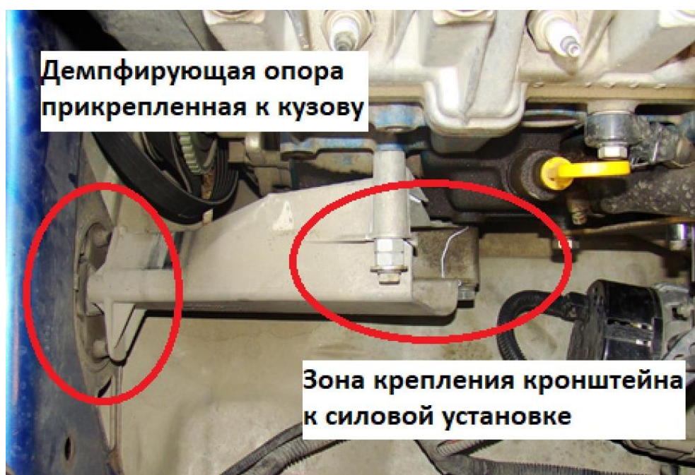
Рисунок 5 – Пример крепления кронштейна силового агрегата
