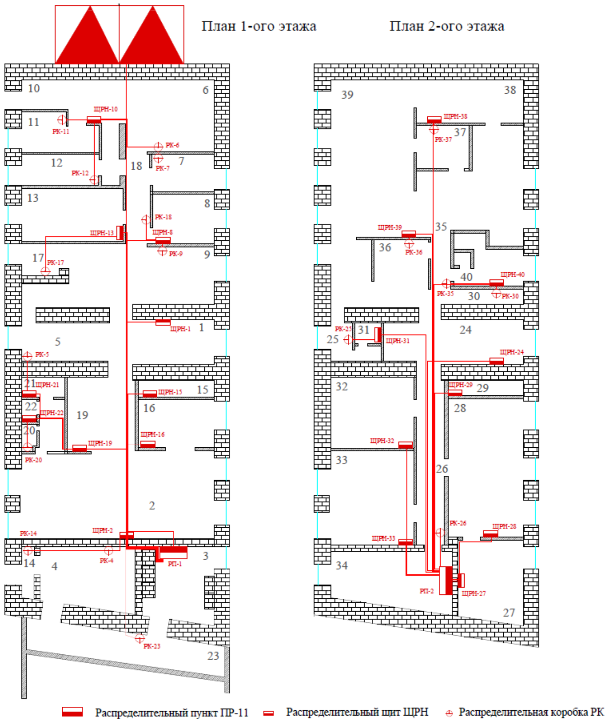
Рисунок 4 – Схема электроснабжения помещений
