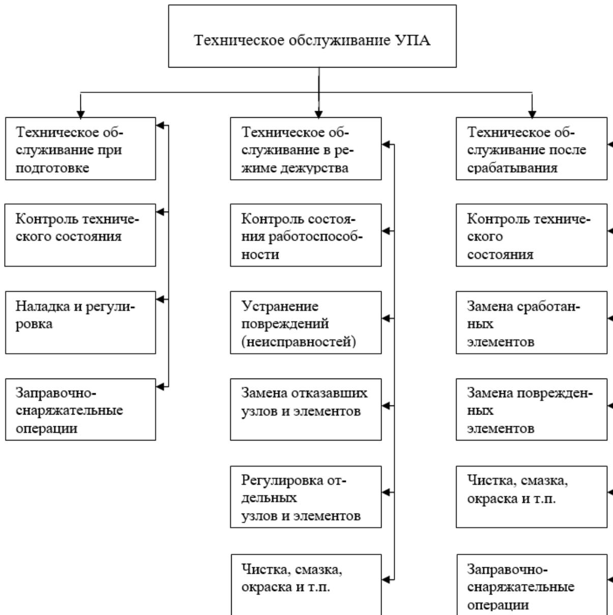
Рисунок 7 – Структура системы технического обслуживания установок пожарной автоматики
