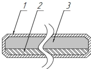
1 – полимерная трубка, 2 – ОТВ 2, 3 – инертный газ
