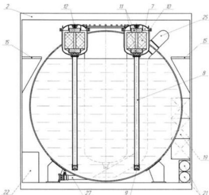
7 – датчик давления, 8 – труба, 9 – изолирующая мембрана, 10 – датчик возгорания, 11 – временной датчик, 12 – электровоспламенитель, 13 – пенообразователь, 15 – стойки, 21 – пожарные рукава, 22 – аккумулятор, 25 – клапан резервуара, 27 – патрубок
