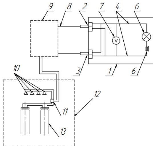
1 – корпус, 2 – штепсельный разъем, 3 – круглый разъем, 4 – линия подачи напряжения, 5 – световой индикатор, 6 – звуковой индикатор, 7 – цифровой вольтметр, 8 – пусковая цепь, 9 – блок питания, 10 – извещатели, 11 – пусковой клапан, 12 – системы АУП, 13 – модуль срабатывания
