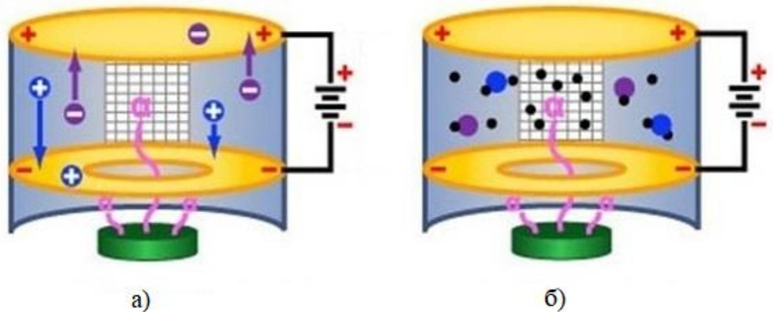
Рисунок 3.2 – Принцип действия ионизационного детектора дыма: а) – альфа-частицы ионизируют молекулы воздуха, и при приложении напряжения к клеммам в цепи возникает слабый ток; б) – частицы дыма попадают в камеру и прикрепляются к ионам, делая их нейтральными. Ток уменьшается.
