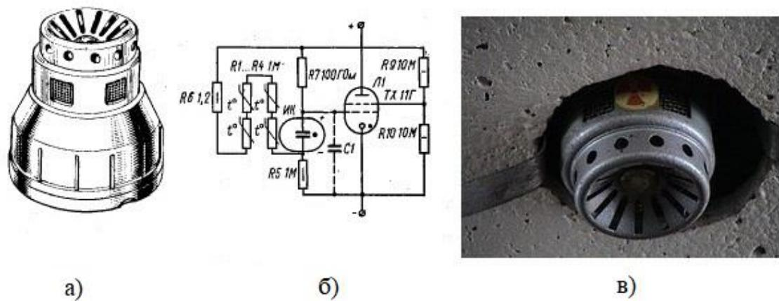
Рисунок 3.1 – Радиоизотопный дымовой извещатель КИ-1:
