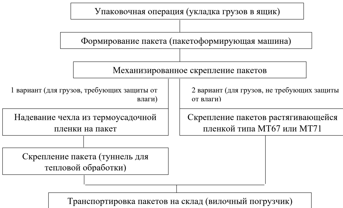
Рисунок 2 – Технология погрузочно-разгрузочных и транспортно-складских работ
