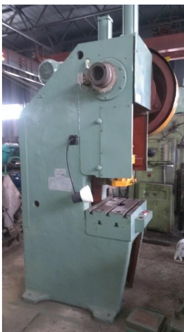
Рисунок 8 – Пресс кривошипный КД2126, усилием 40 тонн
