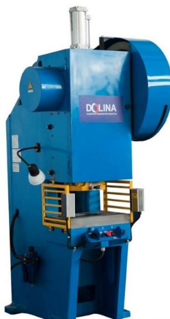
Рисунок 9 – Пресс кривошипный КД2126, усилием 40 тонн с установленной защитой
