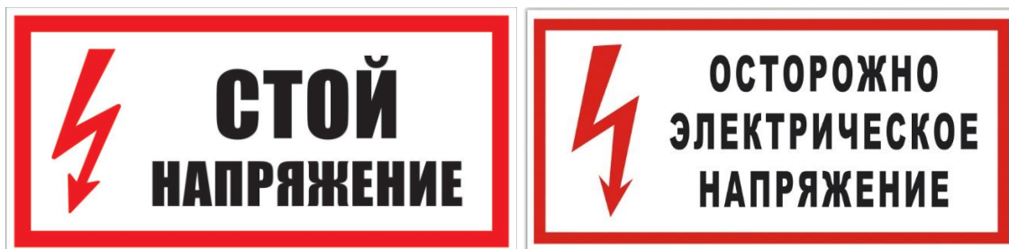
Рисунок 6 - Предупреждающие знаки по электробезопасности при производстве электромонтажных работ
