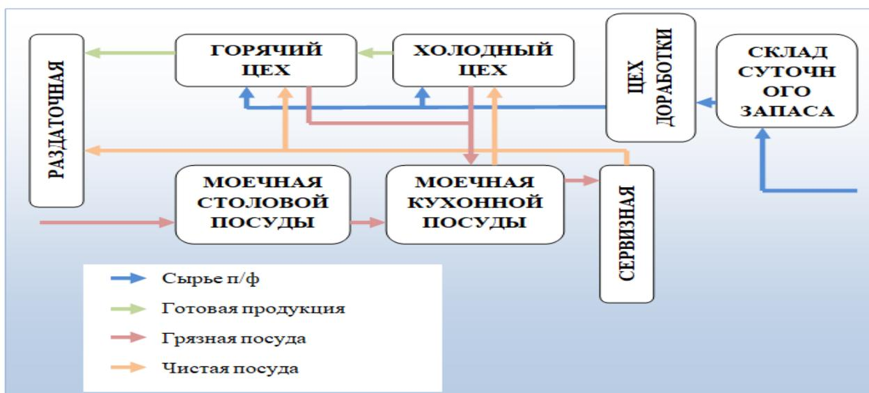
Рисунок 2 – Схема движения потоков на пищевом предприятии
