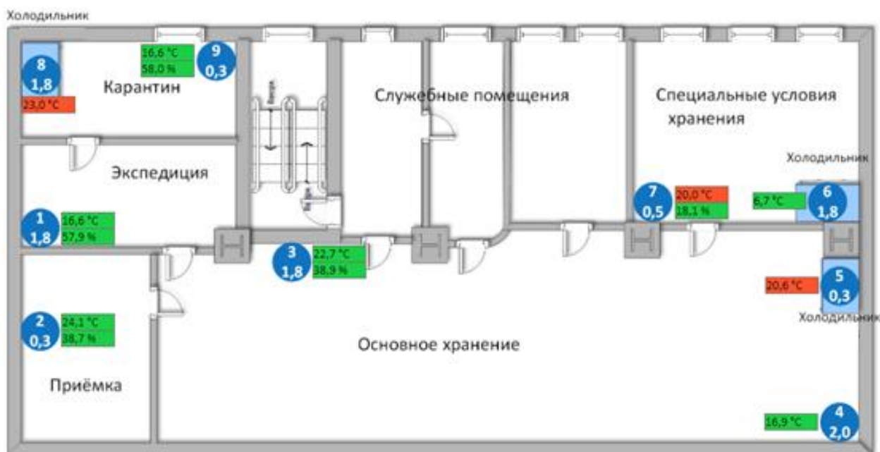
Рисунок 4 – Окно сигнализации распределения узлов температуры и относительной влажности воздуха
