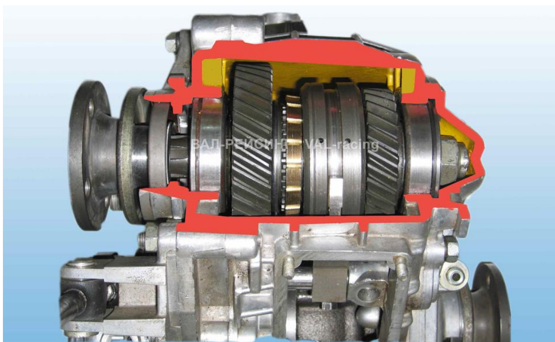
Рисунок 9 – Синхронизированная раздаточная коробка Вал-Рейсинг с пониженным рядом 2,54
