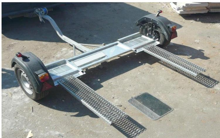
Рисунок 12 – Автоприцеп для перевозки автомобилей " СВ-50"
