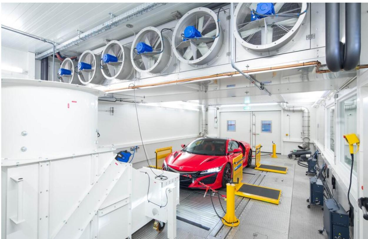
Рисунок 2 - Климатическая камера Weiss Umwelttechnik Thermal Chambers с динамометрическим стендом
