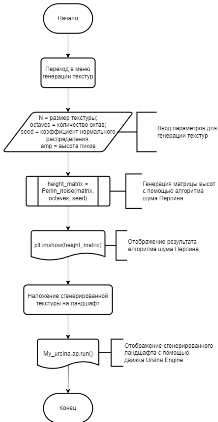
Рисунок 7 – Блок-схема алгоритма работы системы
