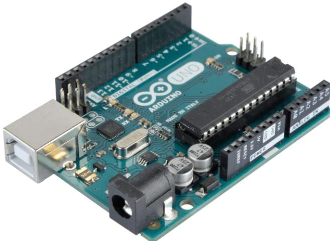
Рисунок 6 – Arduino UNO на базе Atmega328
