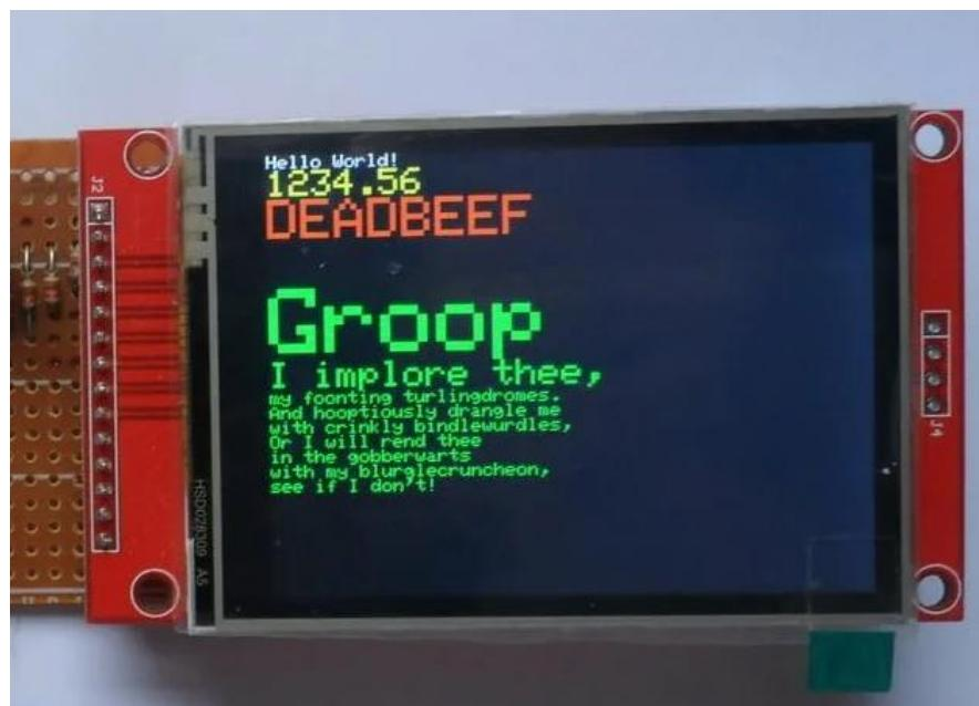
Рисунок 15 – TFT LCD на ILI9341
