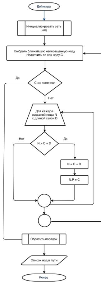
Рисунок 9 – Блок–схема алгоритма Дейкстры
