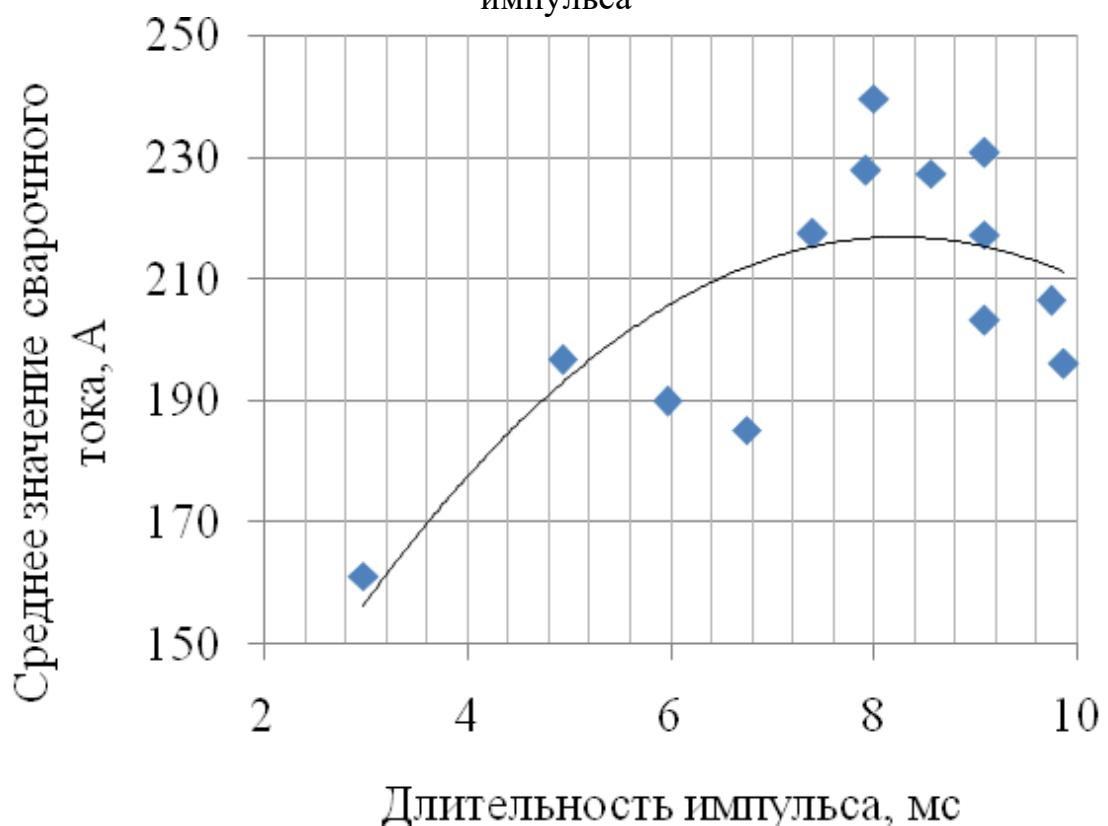
Рисунок 27 – Величина среднего значения сварочного тока в зависимости от длительности импульса
