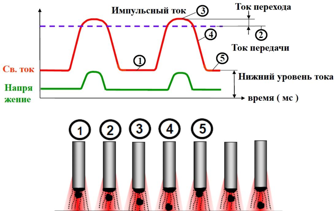
Рисунок 5 – Формирование капли расплавленного металла при импульсной сварке
