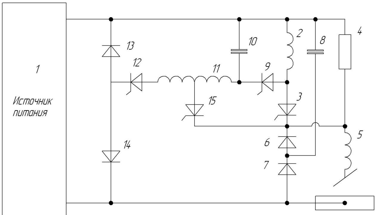
Рисунок 16 – Схема модернизированного источника питания с функцией импульсного управления
