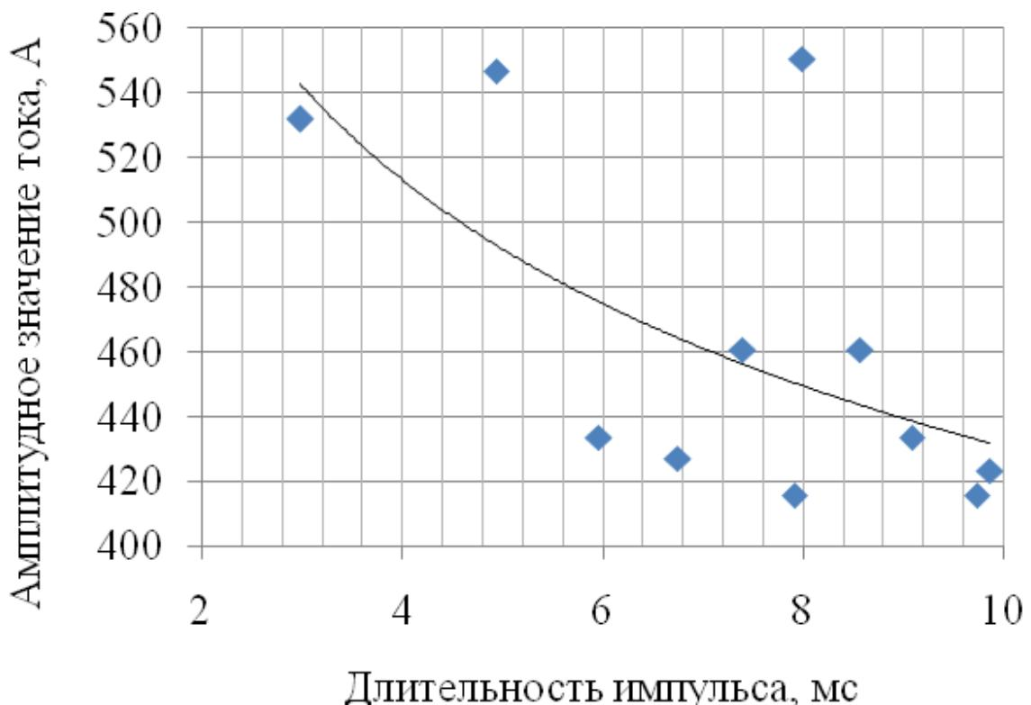
Рисунок 24 – Величина амплитудного значения сварочного тока в зависимости от длительности импульса
