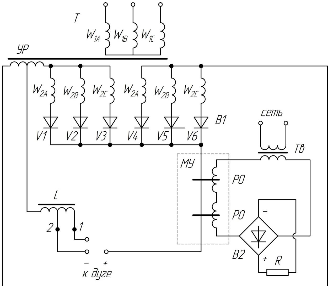
T – силовой трансформатор, V1...V6 – выпрямительные тиристоры, УР – уравнительный реактор, L – дроссель, МУ – магнитный усилитель, РО – рабочие обмотки магнитного усилителя, В2 – выпрямительный мост, Тв – вспомогательный трансформатор, R – измерительный резистор
