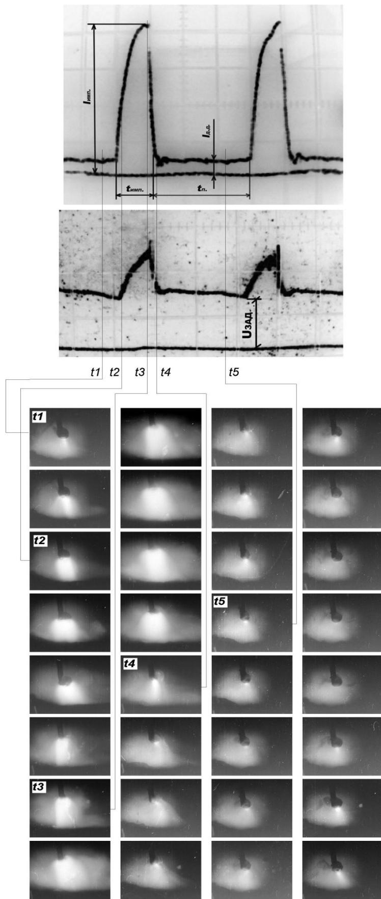
Рисунок 7 – Кинограмма переноса электродного металла при сварке, совмещенная с осциллограммой тока и напряжения при импульсной дуге [1]
