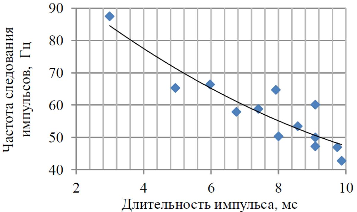
Рисунок 26 – Частота следования импульсов в зависимости от длительности импульса
