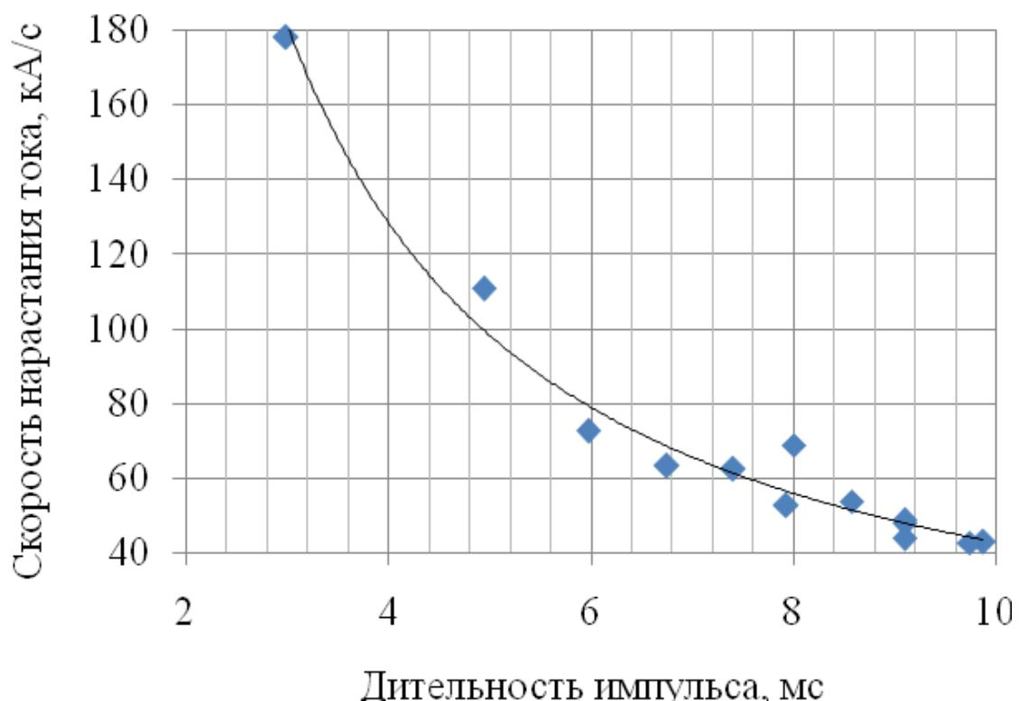
Рисунок 25 – Скорость нарастания тока в зависимости от длительности импульса
