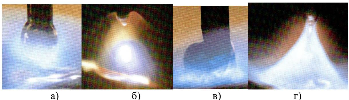
Рисунок 6 – Типы горения сварочной дуги в зависимости от параметров режима и условий управления
