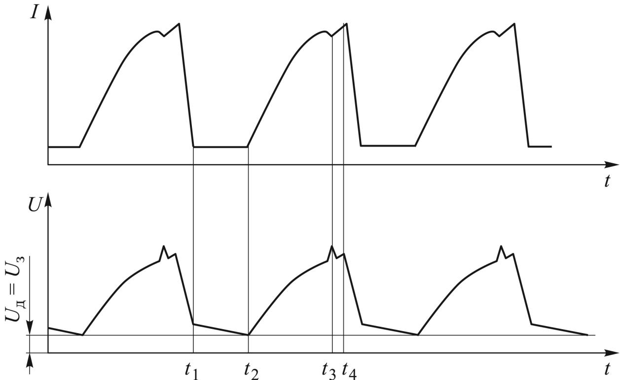
Рисунок 18 – Осциллограммы тока и напряжения согласно предлагаемому способу сварки с импульсным управлением
