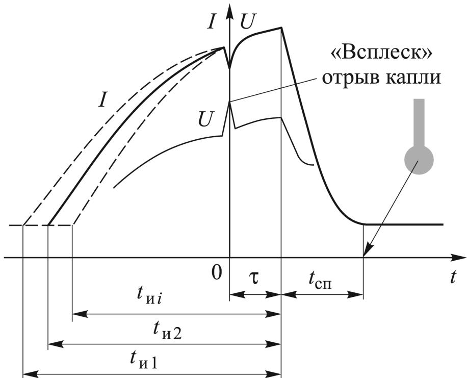
Рисунок 20 – Сущность импульсно-дугового управления горением сварочной дуги
