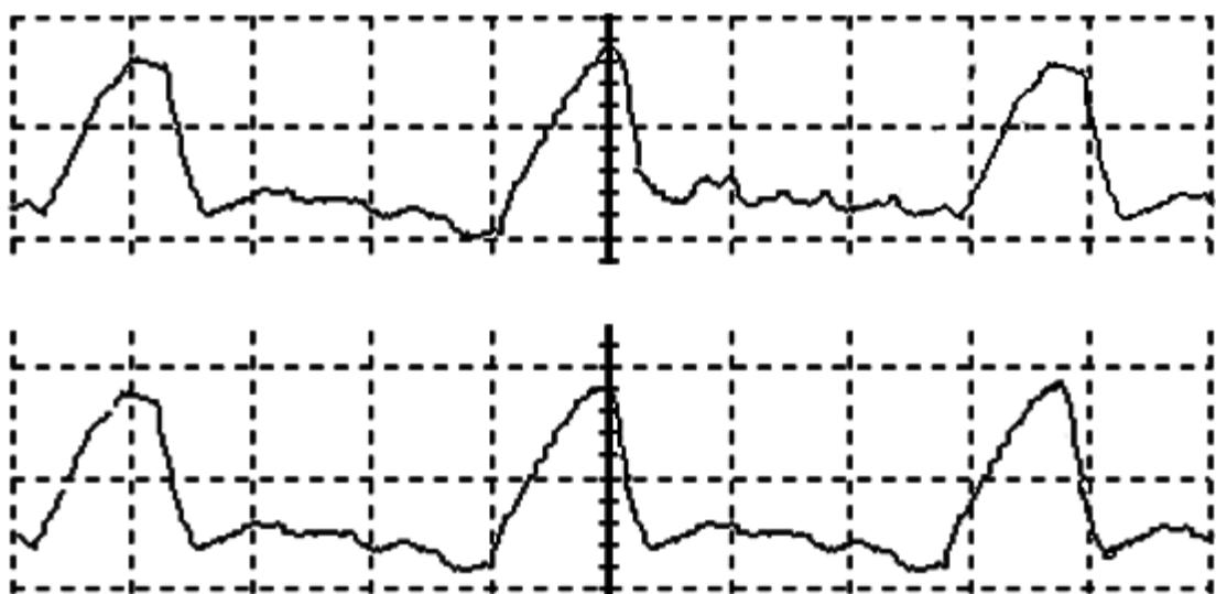
Рисунок 21 – Осциллограммы напряжения при работе модулятора без обратных связей (а) и с обратными связями (б)
