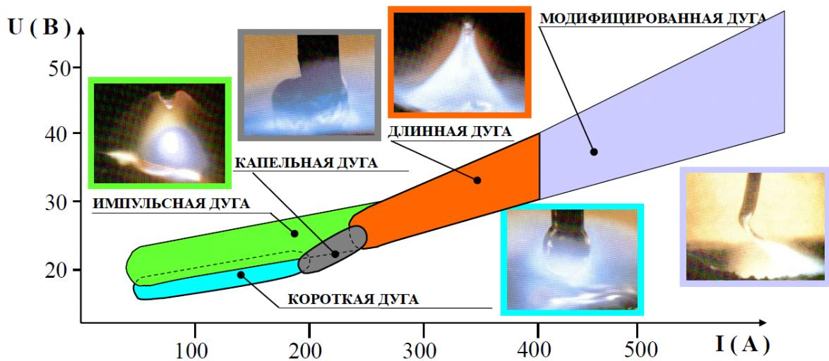
Рисунок 4 – Тип переноса электродного металла при механизированной сварке в защитных газах
