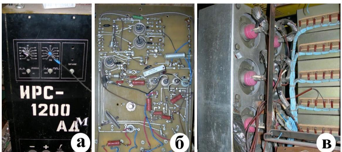
Рисунок 15 – Модулятор ИРС-1200АДМ: лицевая панель (а), схема управления (б), силовые тиристоры и коммутирующий конденсатор (в)
