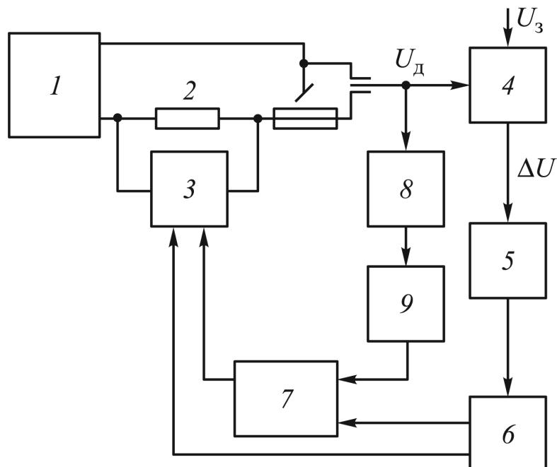
Рисунок 19 – Функциональная схема устройства для сварки с дозированными импульсами энергии
