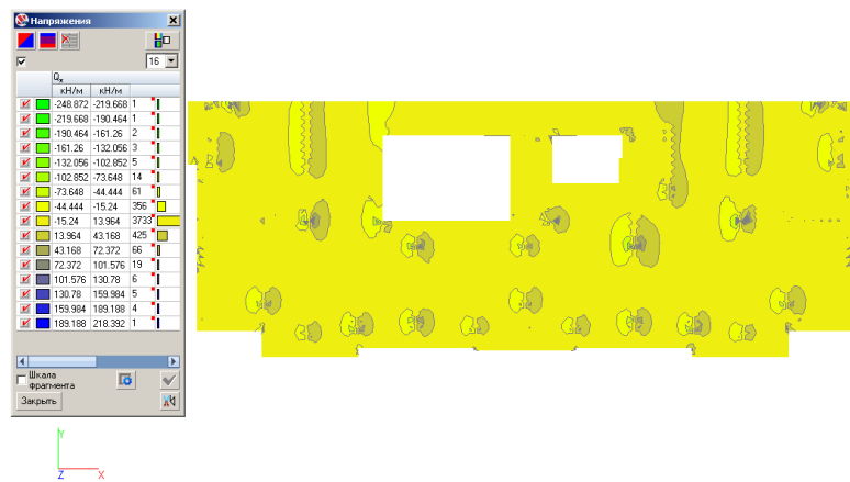
Рисунок 6 – Карта изополей усилий Q_x в плите
