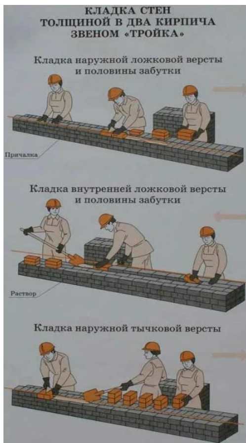
Рисунок 7 – Схема рабочего места каменщиков.
