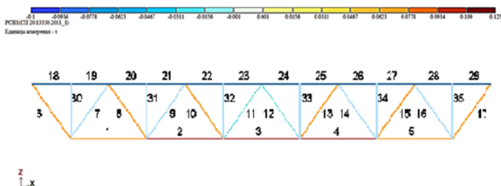
Рисунок 8 – Мозайка усилий N в элементах фермы
