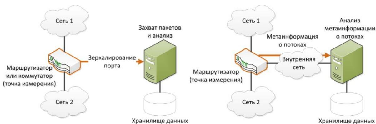
Рисунок 5 – Различия типичных схем packet (слева) и flow-based (справа) анализа
